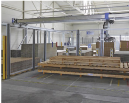
/ Einlagerplatz für Standardmaterialien – von hier aus gelangen die Platten direkt ins Lager.
